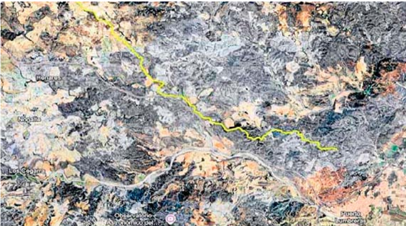
Trazado de la tubería, de 12,5 km de largo, que va de Puerto Lumbreras hacia las inmediaciones de Zarzalico. CEDIDA
